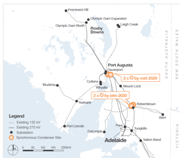
図 2-6 南オーストラリアの同期調相機設置状況
