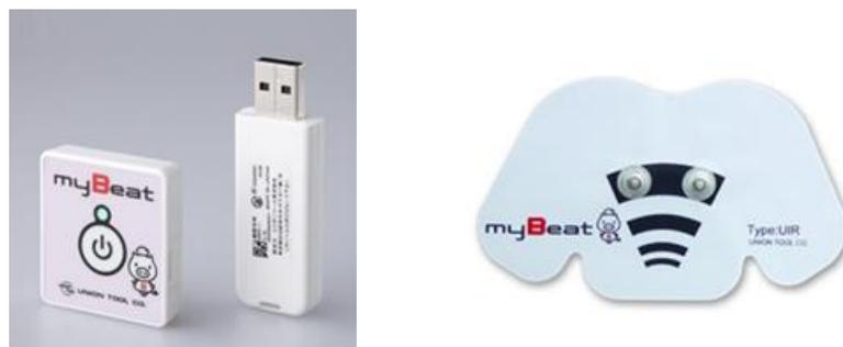
図 3-89 ウェアラブル心拍センサ WHS-1（左）と装着用ディスプレイ電極（右）
