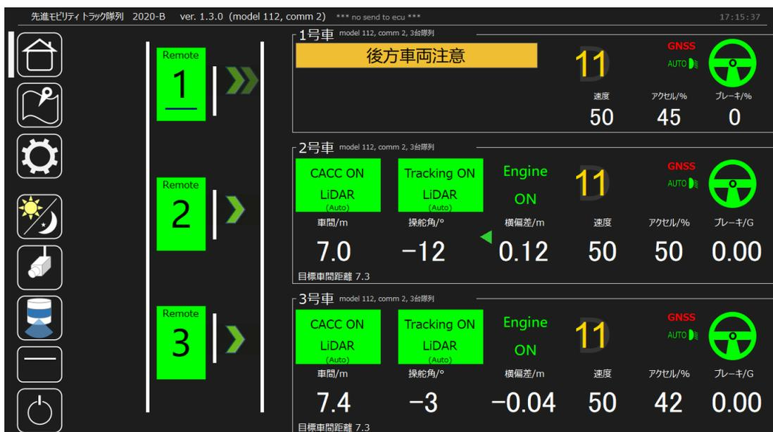
図 3-9 HMI 表示による車線変更支援
