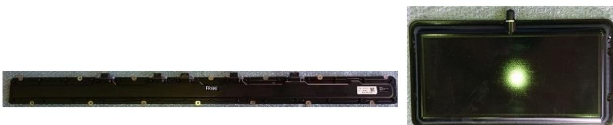
図 3-17 磁気センサ及びRFIDアンテナの外観写真
