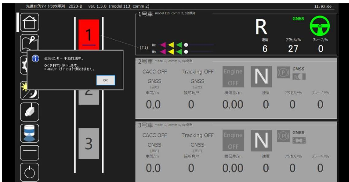
図 3-23 HMI 画面上の磁気マーカ走行支援表示機能
