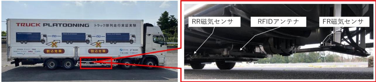
図 3-18 トラックへの磁気センサ搭載位置（その 1）
