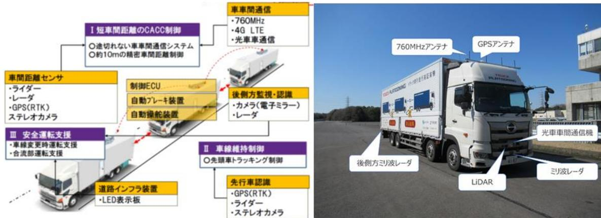
図 3-85 後続無人システムの構成及び実証実験車両の外観
