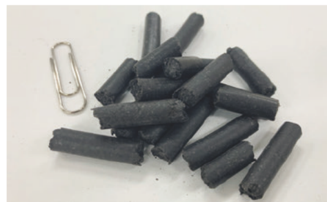
可燃ごみ由来の炭化ペレット(石炭代替燃料)
