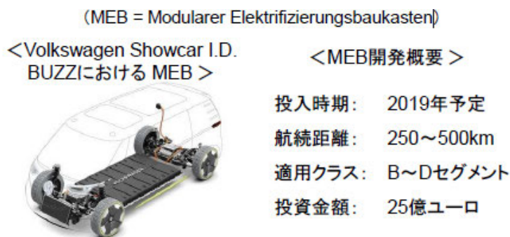
図 10 独 Volkswagen Group の BEV 専用プラットフォーム概要
