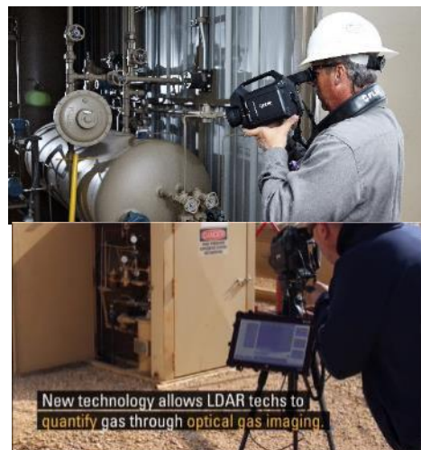
図表2-13：FLIR の OGI カメラ計測
