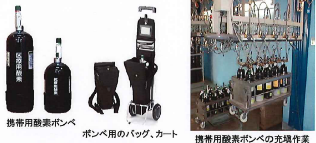
図 2.3-2 液化酸素装置及び携帯用酸素ボンベのイメージ（JIMGA 資料より抜粋）
