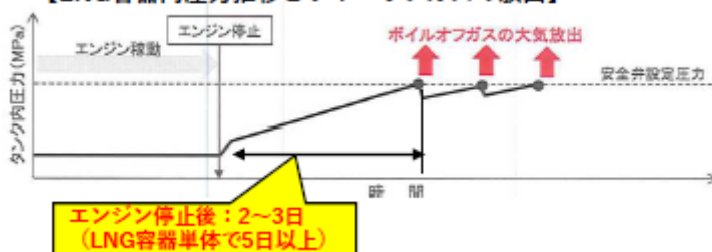
【LNG容器内圧力推移とボイルオフガスの放出】
