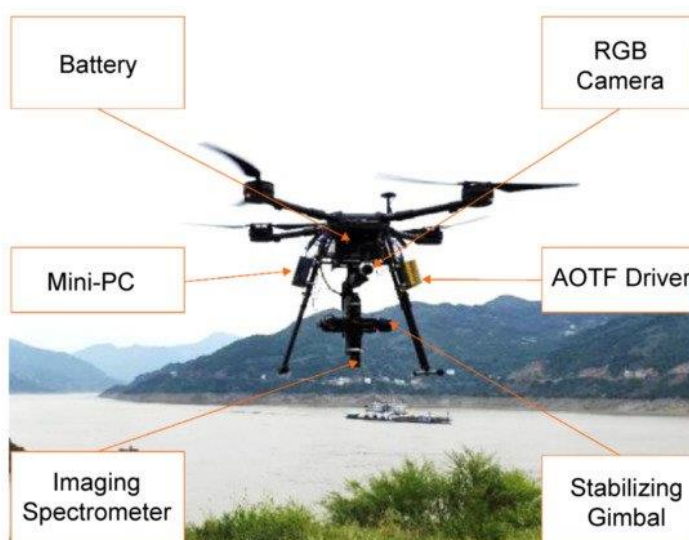
図 2-16 UAV への AOTF センサの搭載概観
