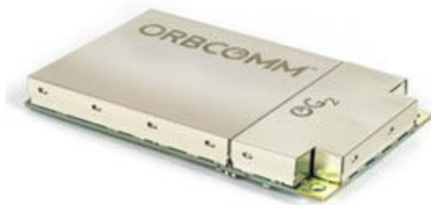
図 2-26 OG2 コンステレーション用地上端末 OG2 Modem
