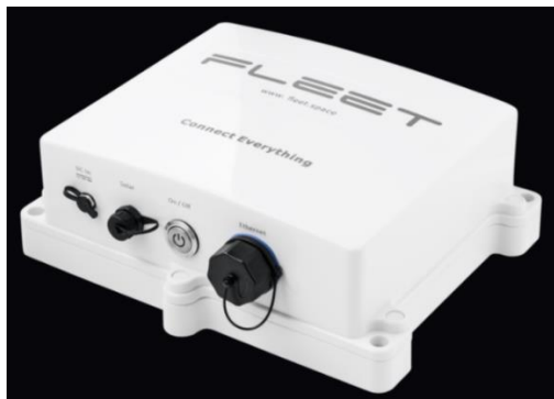
図 2-44 エッジサーバ、LoRaWAN ゲートウェイ、衛星モデムの機能を統合した Fleet 社の The Portal デバイス 出所)Fleet Space Technologies The Portal https://fleetspace.com/portal (2022年 2 月 9 日閲覧)
