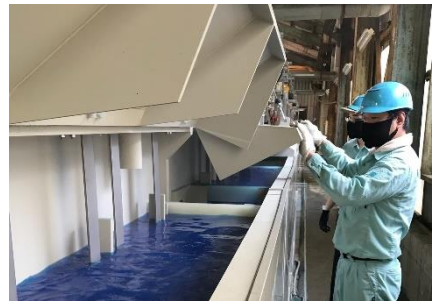
自社設計の銅めっきライン試運転風景
