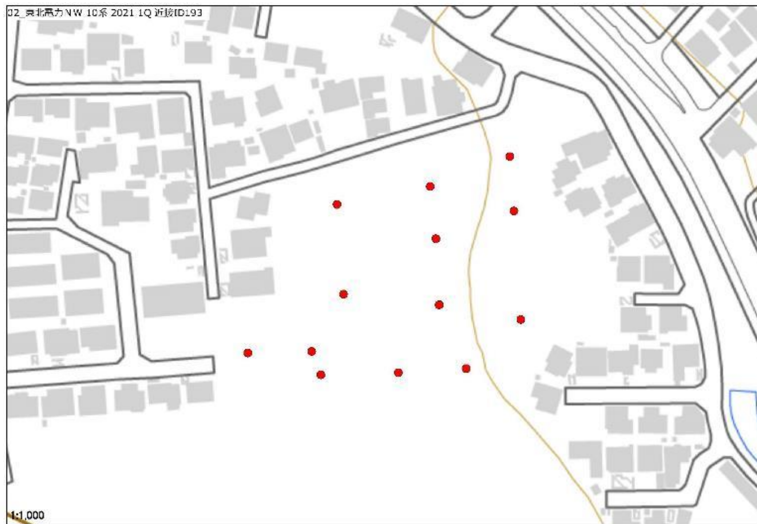
図3-3 戸建分譲地造成への供給に伴う13本の電柱新設
