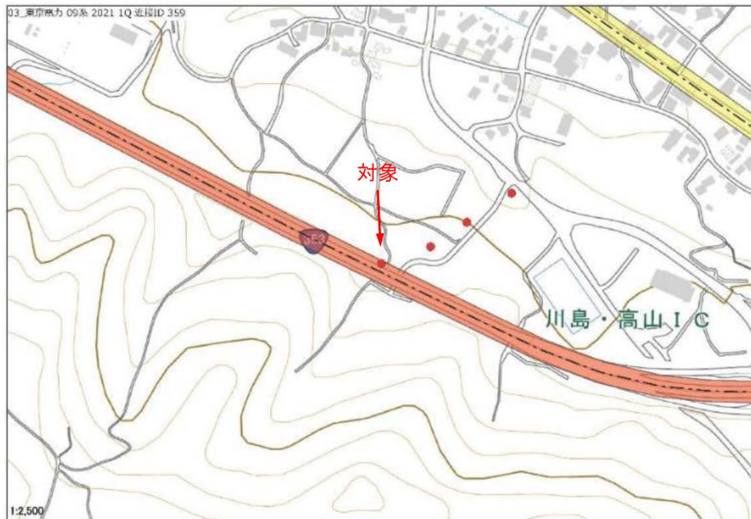
図 1 3 緊急輸送道路沿いの道路案内板への供給に伴う電柱新設(うち 1 本を対象と判定)
