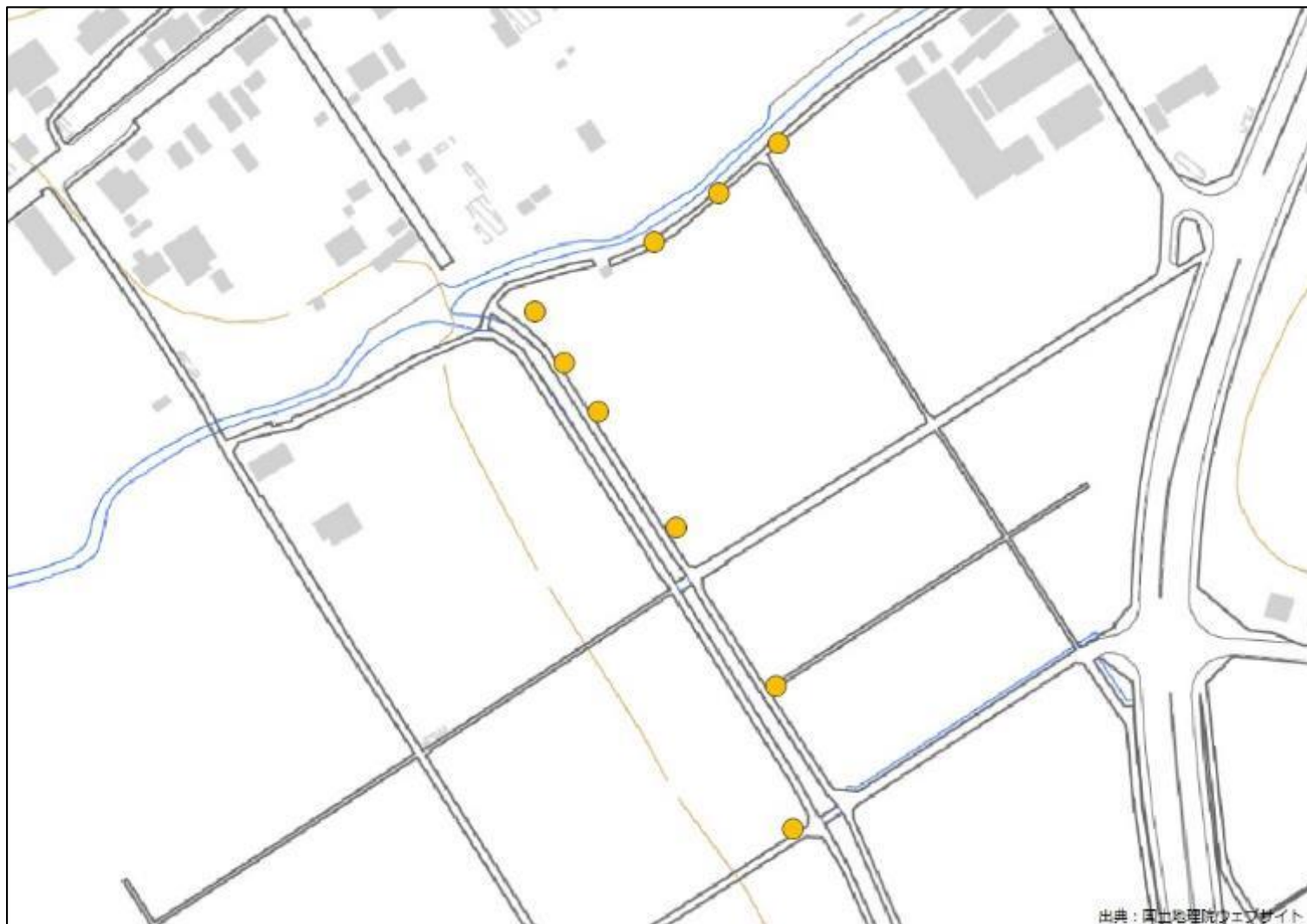
図 2 2 土地区画整理事業での供給ルート構築に伴う 9 本の電柱新設
