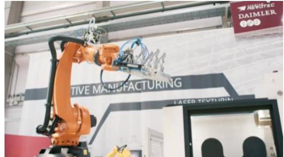
▲ ロボットアームが造形物を粉末除去装置から取り出しているところ
