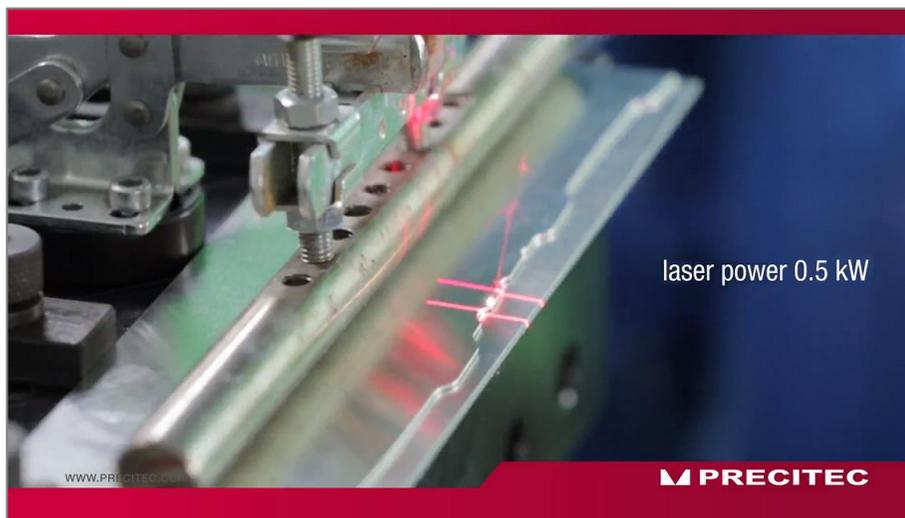
▲ 溶接の前／中／後で形状を計測、レーザーの位置合わせに活用している
