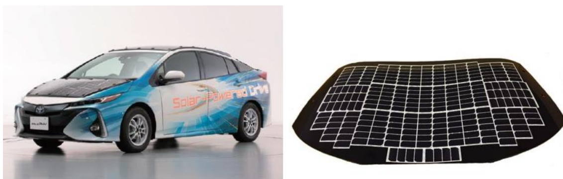
写真 2-4 太陽光発電システムを搭載した公道走行用実証車と搭載したモジュール
