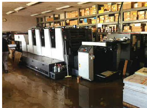
オフセット印刷機周辺に流入した泥水
