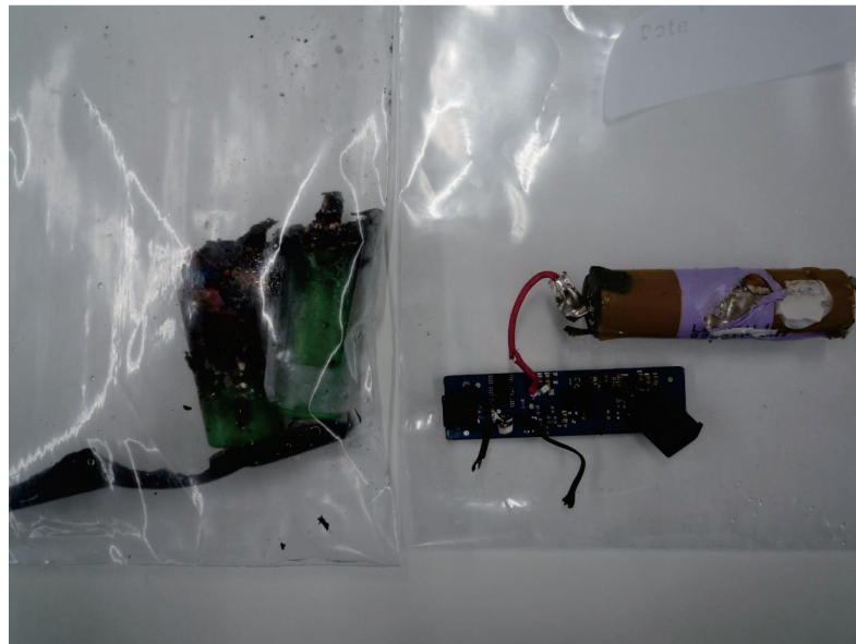
写真4 焼け焦げたリチウムイオン電池
