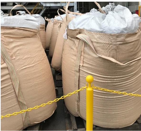
図-1-5-2.区画され、封をした状態で保管されている燃焼灰
