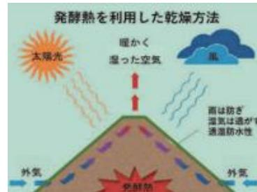
図-1-4-6.乾燥の仕組み
