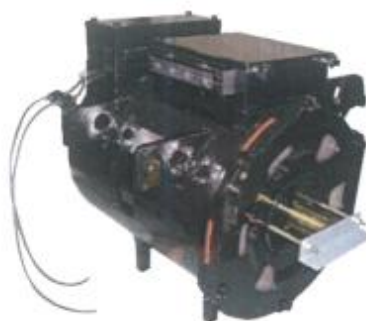
図 4-10：主電動機（誘導電動機）
