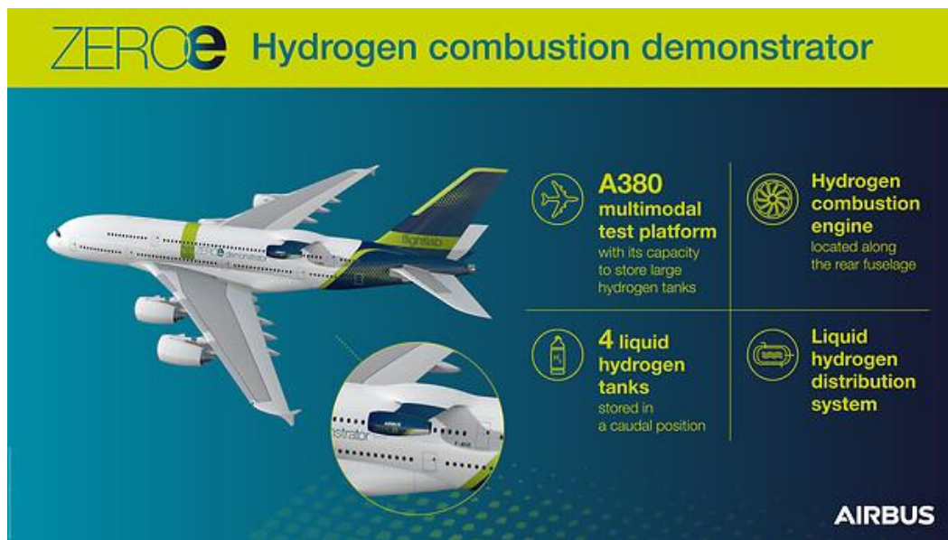
図 3.2 実証試験に用いる試験機の概要 3)
