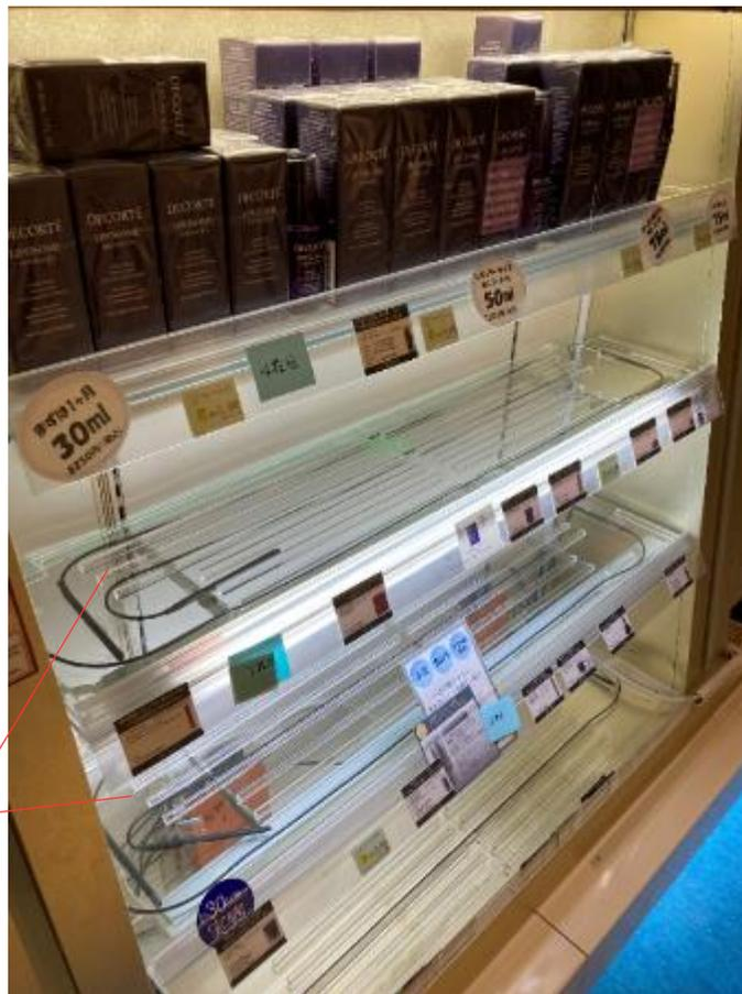
棚板上にケーブルアンテナを設置し、各棚の上方方向に向けてRFIDタグ読取範囲を構築
