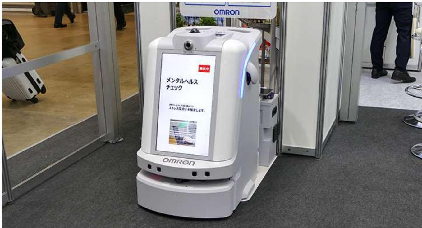
図2-3-39 掃除しながら万引き抑止ができるサービスロボット「Toritoss」(オムロン)
