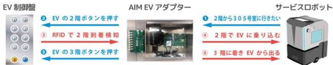
図 2-1-10 : AIM ROBOTsエレベータソリューション (EVアダプターとロボットの動き)
