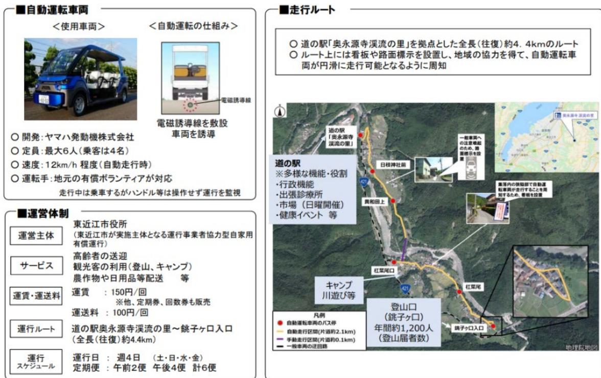
図 4-8 自動運転システムの概要と構成
