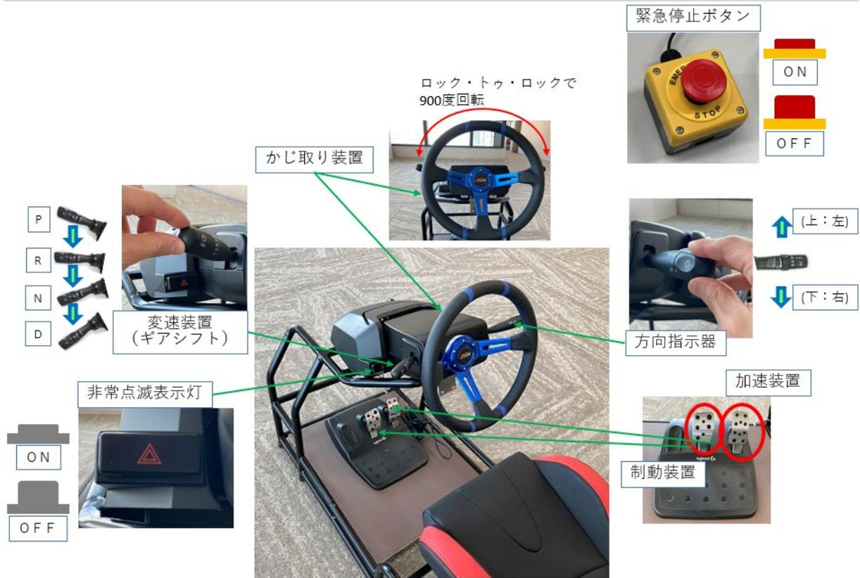
図4.4.3.18 遠隔操縦装置の操作、並びに緊急停止ボタンの操作
