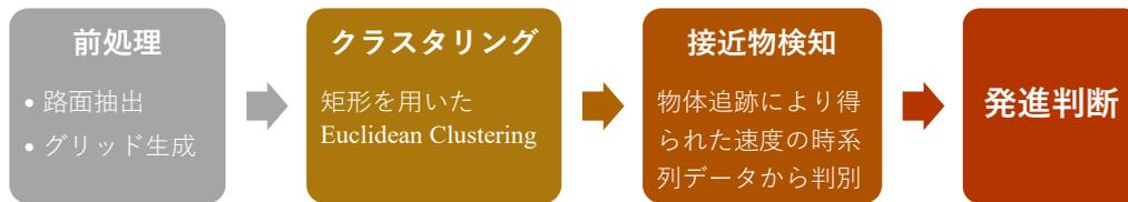
図 4.1.6-2 発進判断までの提案手法の処理
