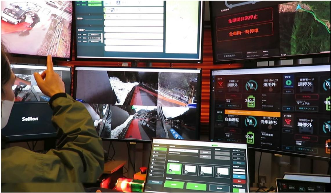
車両から、異常状態通知、または通話要求があると、警報とともにパトランプが点滅、遠隔オペレータは遠隔システムを利用して、当該車両の状況把握に努める
