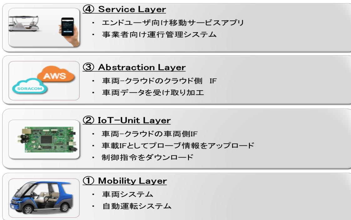
図 4. 4. 1-1 自動運転モビリティサービスの 4 層構造
