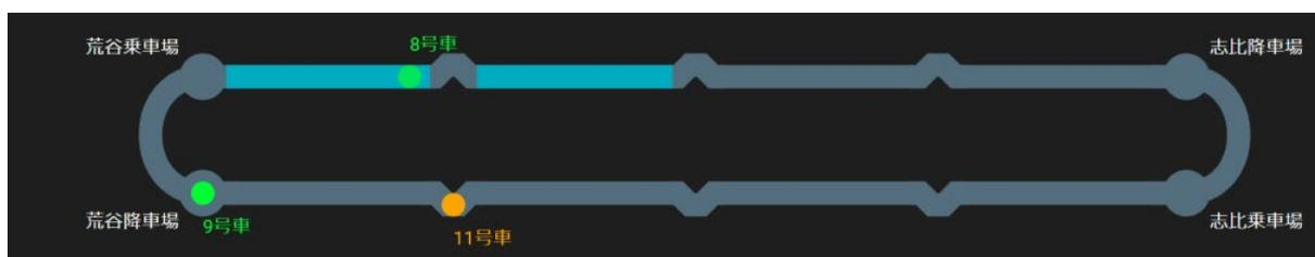
(c) 11 号車がひとつ前の待避所で待機しているため、8 号車が荒谷乗車場を発車できる
