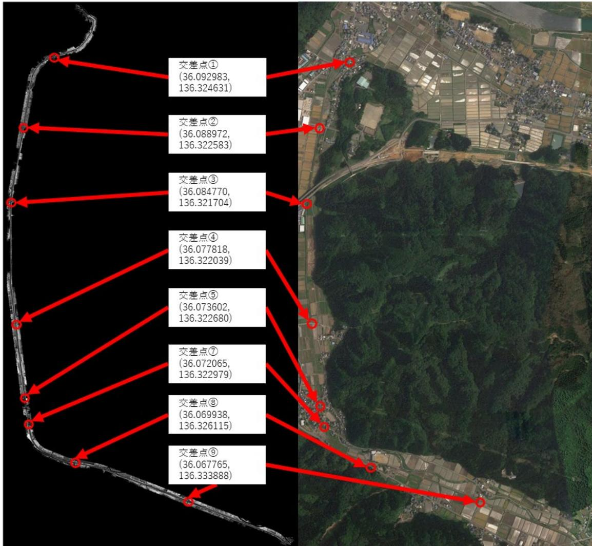
図 4.1.1-2 高精度地図上と航空写真の交差点位置
