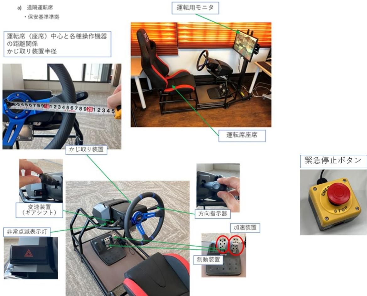
図4. 4. 3. 17 遠隔操縦システムのセンター装置類
