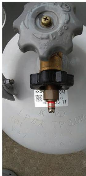
（中） 高圧ホースがちぎれているが、張力式の高圧ガス放出防止機構が作動している
