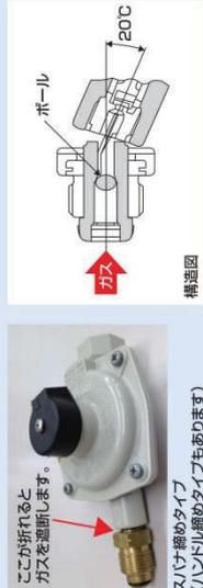
折損対応型単段調整器は、地震や台風で互が落ちたり落雪等で調整器に異常な重量が加わったりすると、左図のように入り口接続部が折れ、20℃以上傾くとボールが栓をしてLPガスの流出を防止する機構が付いています。
