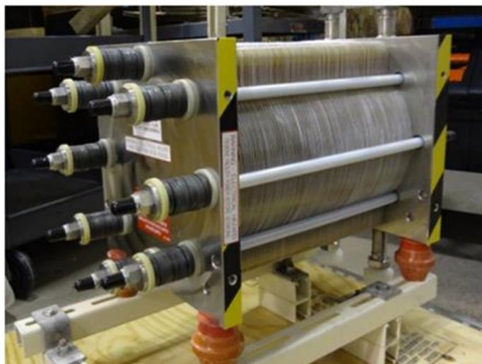
Teledyne Energy Systems 社の電解装置の実験の様子
