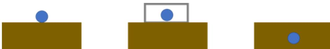
図 2-114 配線敷設方法(左:配線転がし、中:ケーブルトラフ、右:地中埋設)
