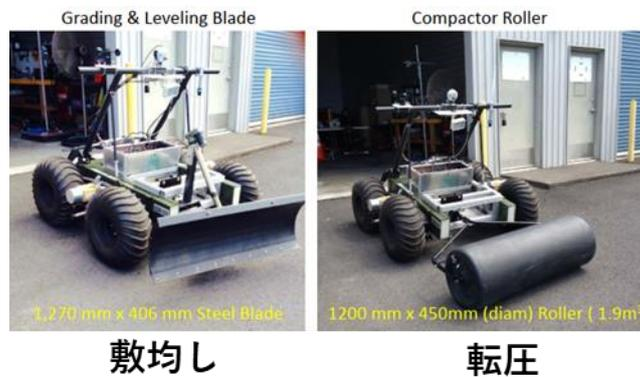
図 2-117 建設機械の例(敷均し、転圧をアタッチメント変更で対応)
