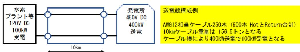
図 2-146 直流 120V 系による送電の検討例
