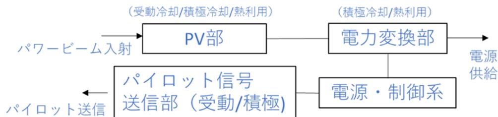
図 2-144 受電システム基本構成
