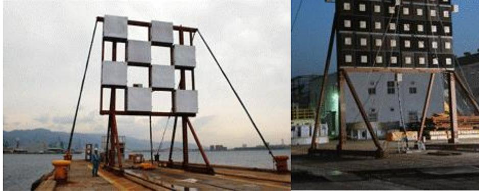
図 4-21 実験で用いられた送電装置(左)及び受電装置(右)
