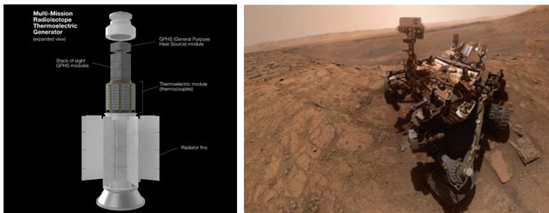
図 4-10 マルチミッション RTG(左)とマルチミッション RTG が用いられている火星探査ローバ(右)
