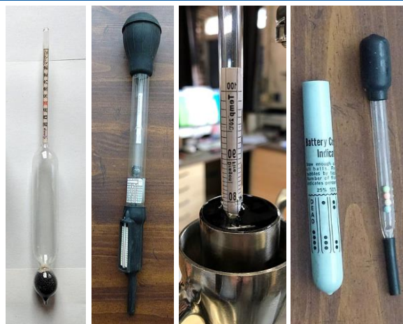
図 2: 比重計の例: (左から右に) 乳比重計、不凍液計、アルコール計、バッテリーテスター (水銀またはその他の高密度物質を充填したもの: パルマ県食品博物館 2019, Butch 2015b, Michel 2017, Butch 2015a)
