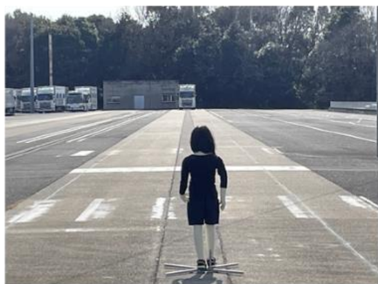
図 4-43 試験結果（前方遠方 LiDAR・カメラ/自車線・直線/人）
