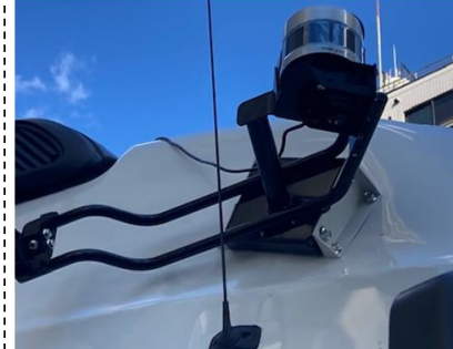
図 4-34 実装状態（側面カメラ、後側方 LiDAR・カメラ）
