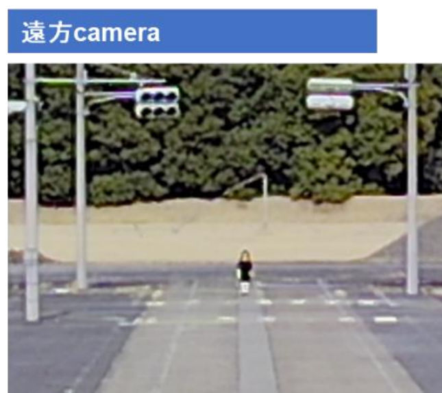
図 4-43 試験結果（前方遠方 LiDAR・カメラ/自車線・直線/人）
