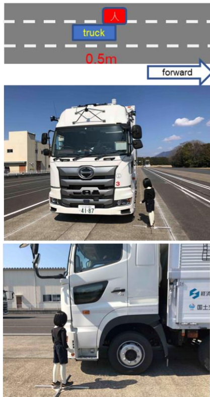
図 4-68 試験結果（側面カメラ/車両前端横）
