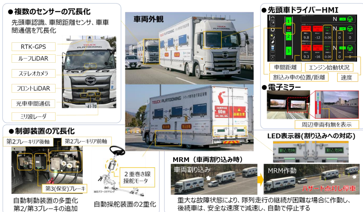
図 4-1 後続車無人隊列走行（電子牽引）で搭載した機能
