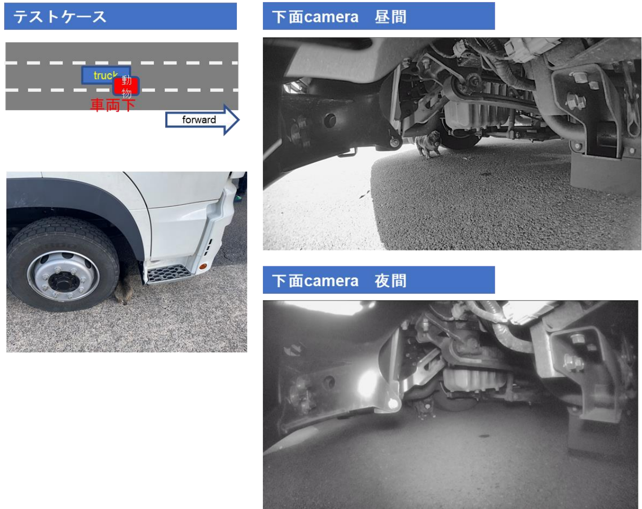
図 4-71 試験結果（下面カメラ/前輪前/小動物）
