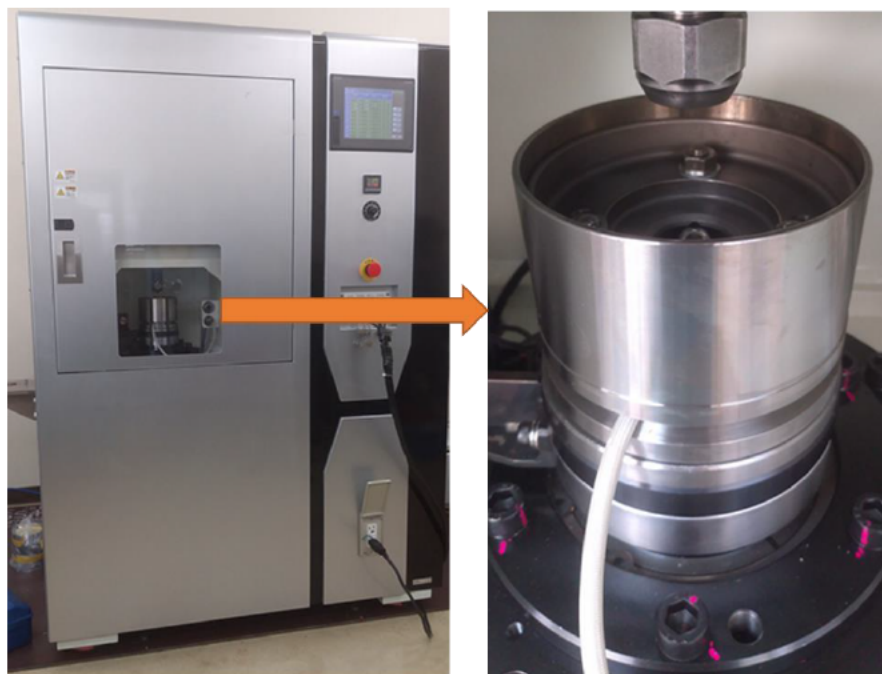
図 2-8. 標準型四球摩擦試験機全景および試験部分
