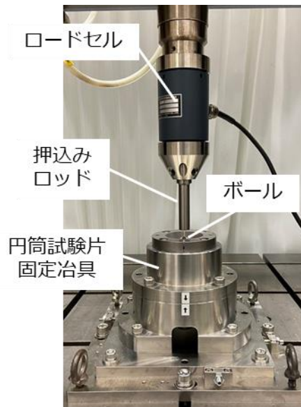
図 2-14. ボール通し試験機
