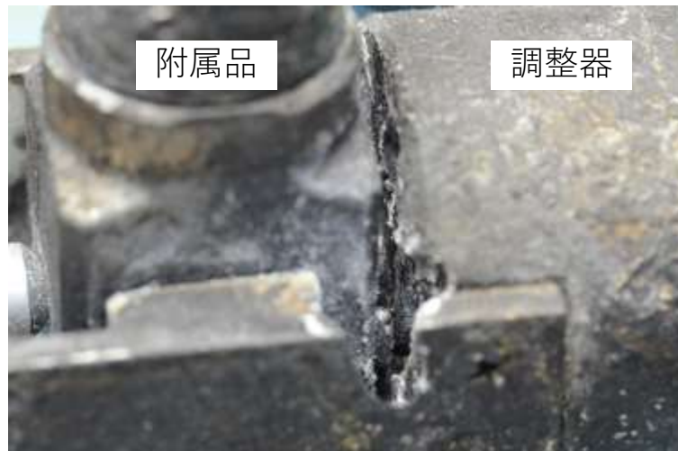
図 3 事故が発生したときに使用していた調整器(ヨークの拡大図)
