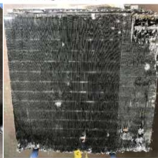
図 5 クーラーフィンの溶損および目詰まり状況 (①ファン側および④ヒーター側は外観による目視確認が可能である。その他の部分は事故後の切断面であり、事故時には目視検査ができない。)
