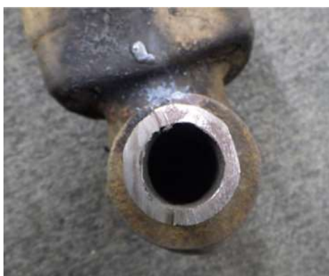
図 4 ブリーダー弁の切断点検結果
