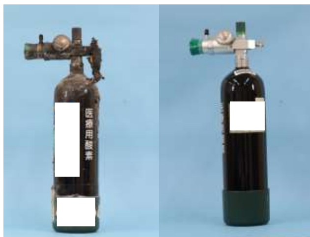
図 2 容器、附属品、調整器の外観(左:事故が発生したときの使用品、右:同等品)
