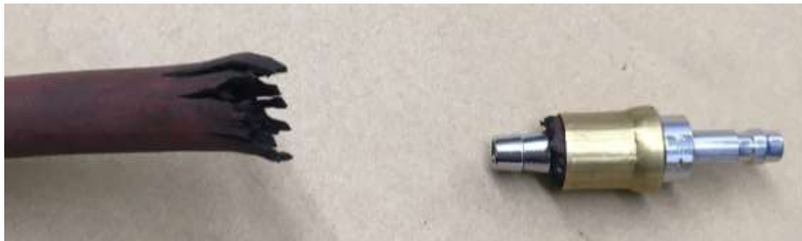
図 5 ホース破裂後に炎を発見した箇所
