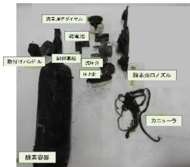
図 3 現場から回収された事故物件（大阪市消防局 提供）
