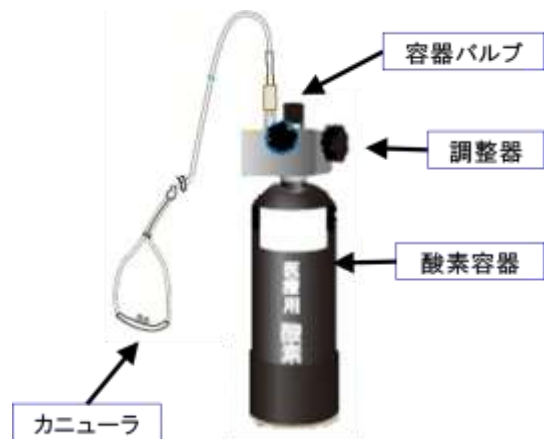
図 1 在宅酸素装置のシステム
