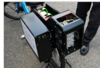
県内企業の(株)エノモト製のGDLを用いて日邦プレジジョンが開発した燃料電池スタックを採用（写真手前）
