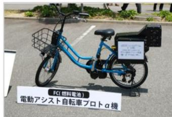
お披露目された電動アシスト自転車（後部の箱が電源となる燃料電池）
