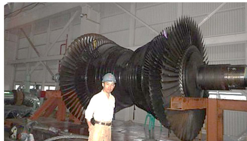
インドネシア：富士電機製の地熱蒸気タービン (110MW)
