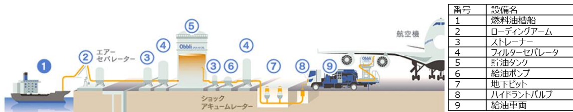
図 2.4 ケロシン燃料におけるハイドラントシステム全体像 3)
