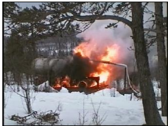
図 1-2：火災時のタンク。白煙は、エマルジョンマトリックスの分解を示す。
