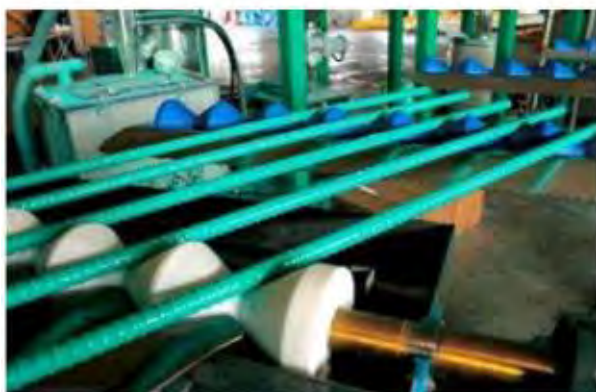
図 9.1 エポキシ樹脂塗装鉄筋使用例
