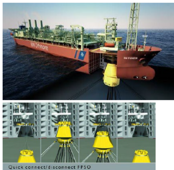
図 6. 1. 1. 6 : Disconnectable Turret 方式
