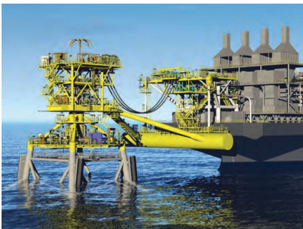
図 6.1.1.2 : Yoke Tower 方式
