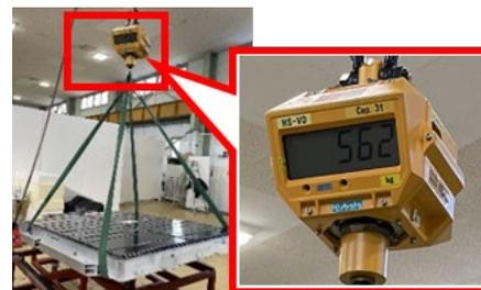
図 2-1-1-5 駆動用バッテリー離脱と重量計測
