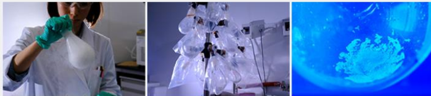
写真2 合成された「特殊ペプチド」は最終的に凍結乾燥装置で精製されて(左・中央)、粉末状の固化物となる(右)。試料の入ったフラスコが凍結乾燥装置に設置されている様子(中央)
