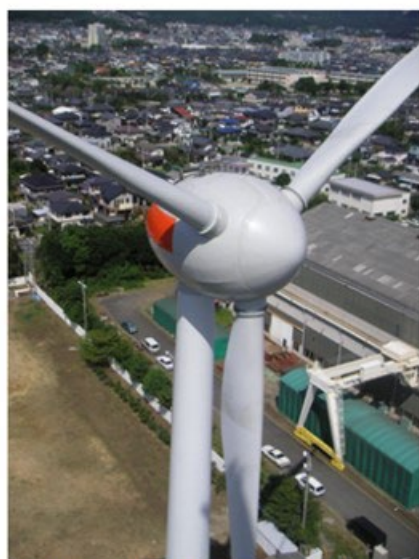
E40/600kW風力発電システム(実技訓練用)
