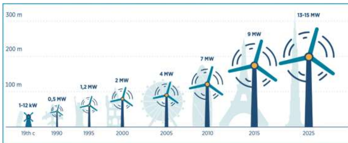
図 6-14 風力タービンの進化（大きさ、定格電力）
