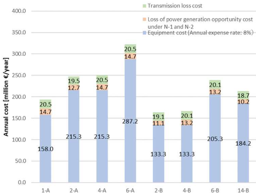
図 4-7 HVAC と HVDC を組み合わせた洋上風力発電グリッド構成案 8 パターンの年間経費の試算結果
