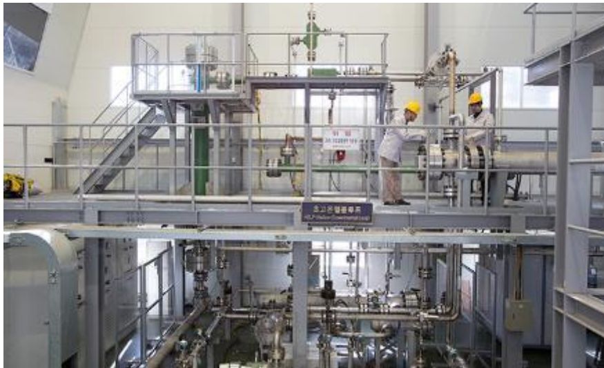
図表2-54 高温ヘリウムループ試験装置
