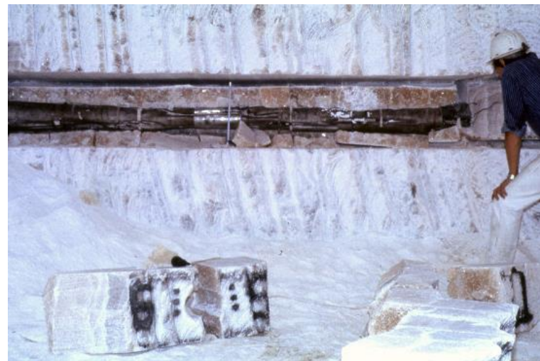
図表2-49 過熱試験による塩の挙動確認
