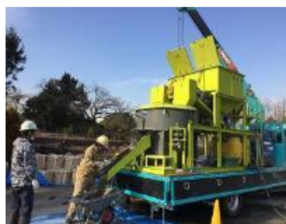
▲車載式舗装材製造プラント「モバコン」
