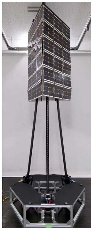
図 2-116 展開・収納機能を持つタワーの BBM(ブレッド・ボード・モデル)
