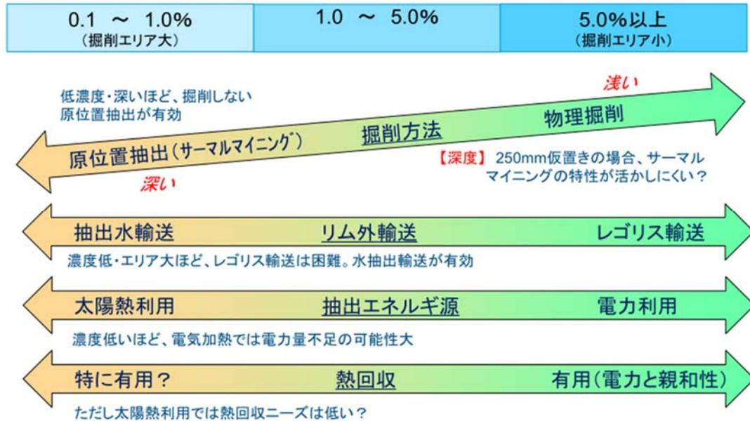
図 2-4 レゴリス中の含水率の変化に伴う手法・技術比較結果
