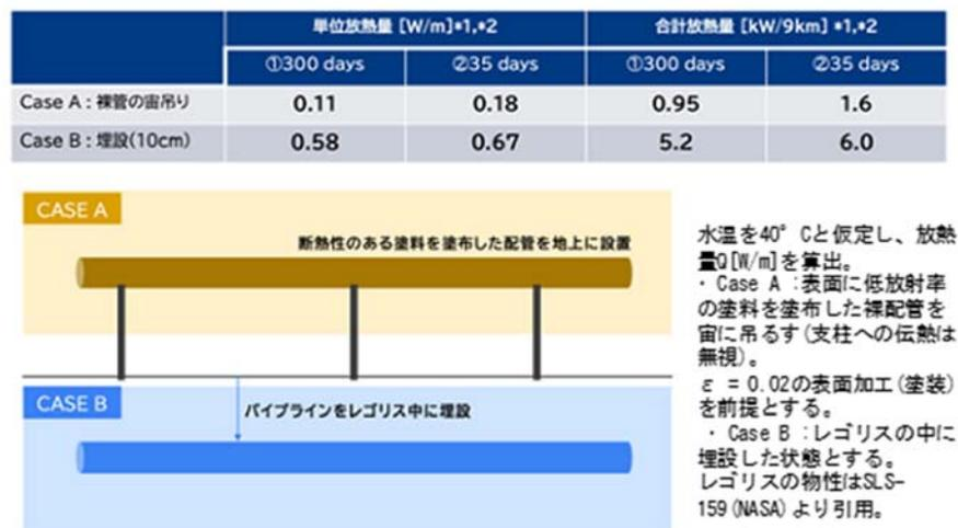
図 2-66 水輸送パイプ凍結防止に必要な電力要求
