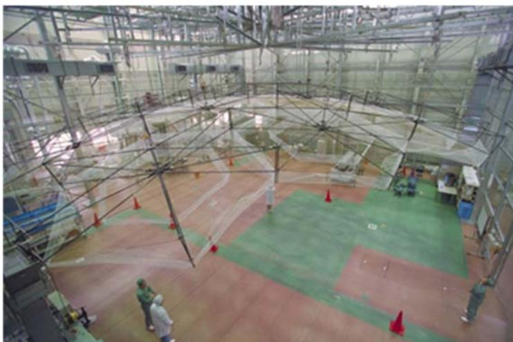
図 2-93 ETS-VIII 搭載大型アンテナ(外径最大寸法:約 19 メートル×17 メートル)
