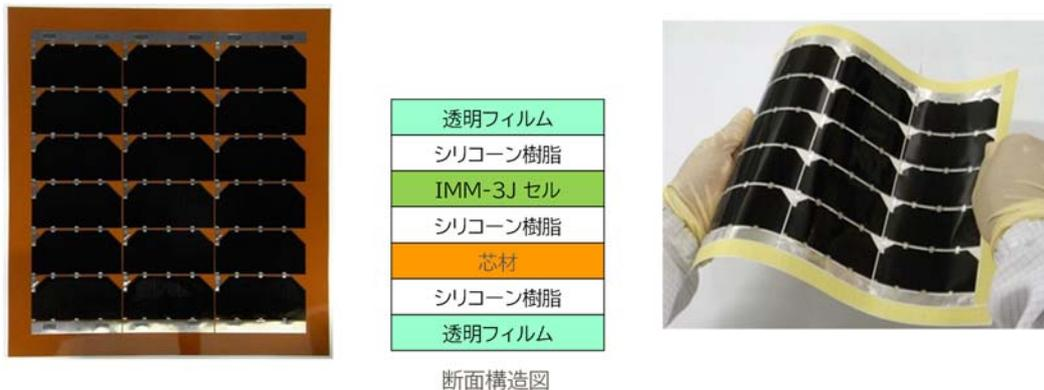
図 2-100 フィルムシートの外観と構造
