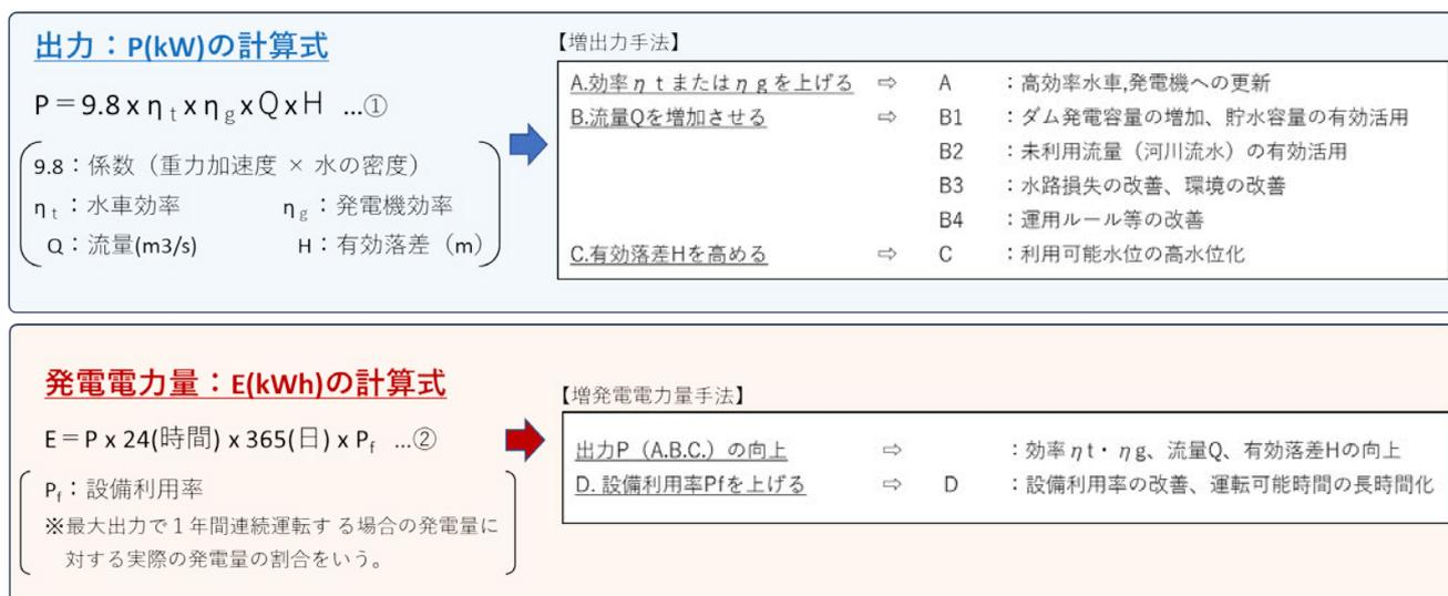
図 3-1 増出力・増発電電力量手法の基本的な考え方
