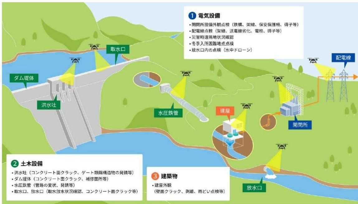
図 3-24 ドローンによる水力発電設備点検のイメージ図
