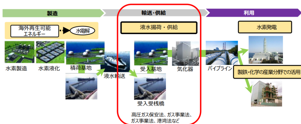
図 3.2 湾岸部において液化水素受入から水素供給を行うイメージ（１―①） 2
