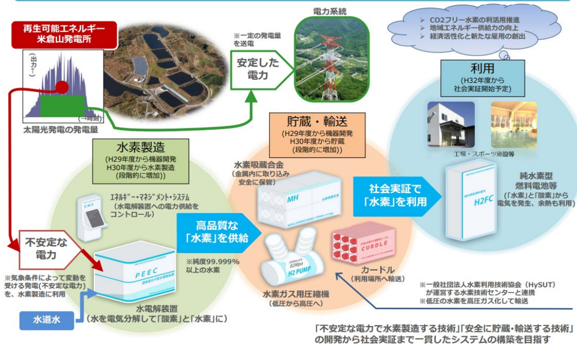
図 3.15 CO2 フリーの水素エネルギー社会実現に向けた P2G システム (4-②) 11
