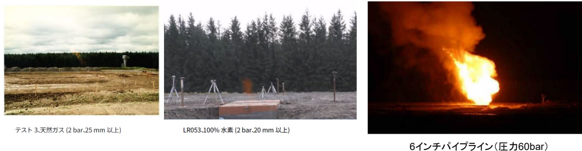
図 4.4 H100 Fife における水素火炎の可視化実験 21
