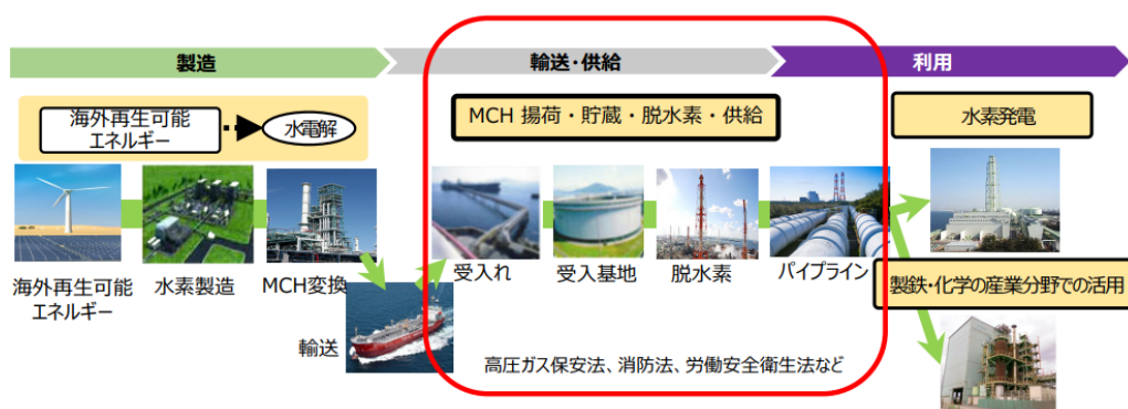
図 3.3 湾岸部において MCH 受入から水素供給を行うイメージ（１―②）
