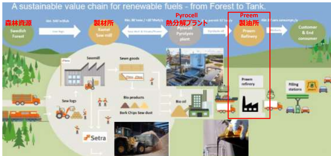
図 2.2.7 Pyrocell 熱分解プラントを含む木材から燃料油製造工程（同社 HP）
