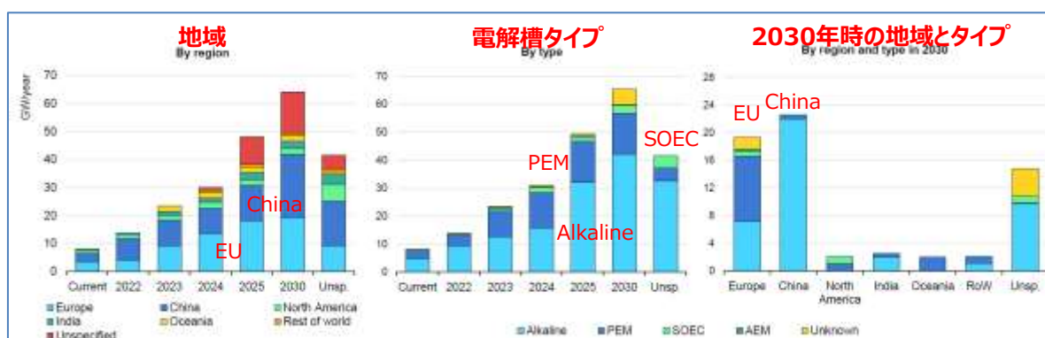
図 2.3.18 電解槽製造側からの電解槽容量見通し 6)
