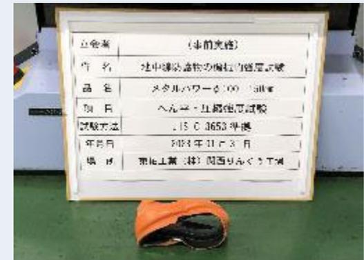
\* 可とう管(L=50mm)については、試料長が短く試験中に試料が傾いてしまい試験方法とおりに試験が実施することができなかったため、強化可とう管1試料のみ実施し、角型多条敷設管と波付硬質合成樹脂管については協議の上、試験を中止した。
