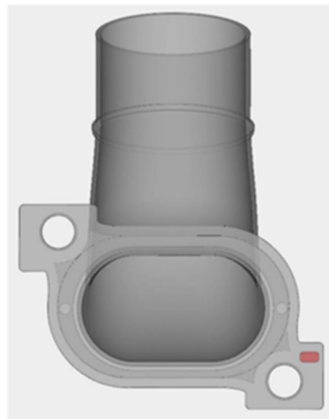
図 2-3-1-2 埋め込み欠陥の位置、寸法
