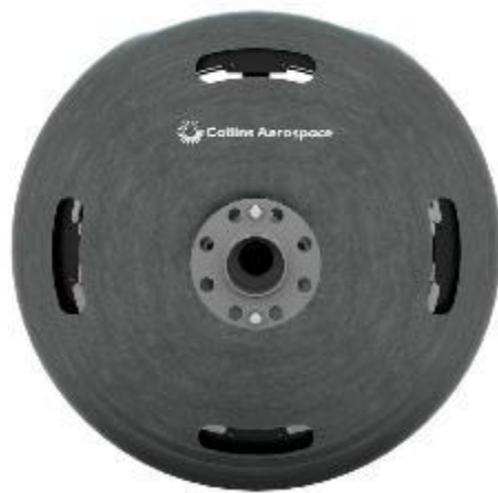
Airlander 10向け永久磁石搭載型 推進用モーター 出力：500kW 回転数：2,000RPM 出力密度：9kW/kg
