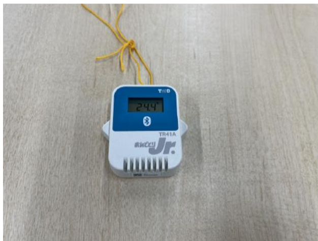
温度データロガー（おんどとり）による屋外温度・室内温度の計測
