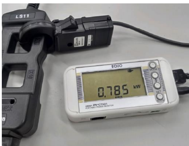
クランプ式電流データロガーによる電流値及び消費電力量の計測
