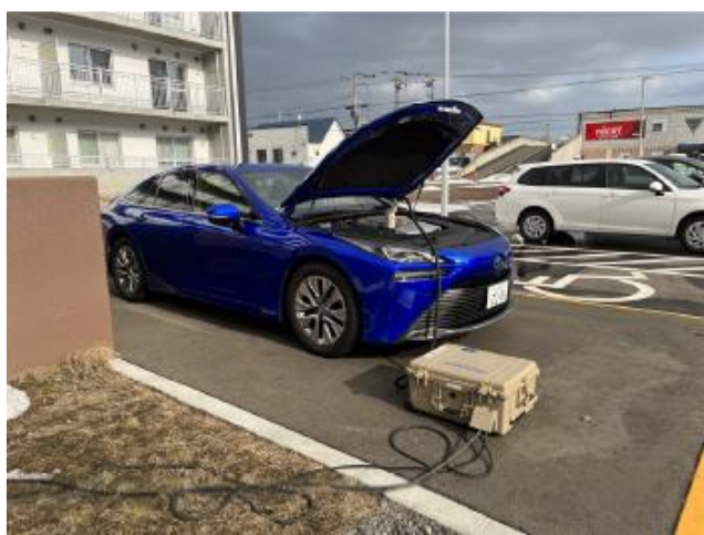
MIRAI⇒外部給電器（ニチコン(株)パワー・ムーバー®）で白鳥台集会所に給電開始
