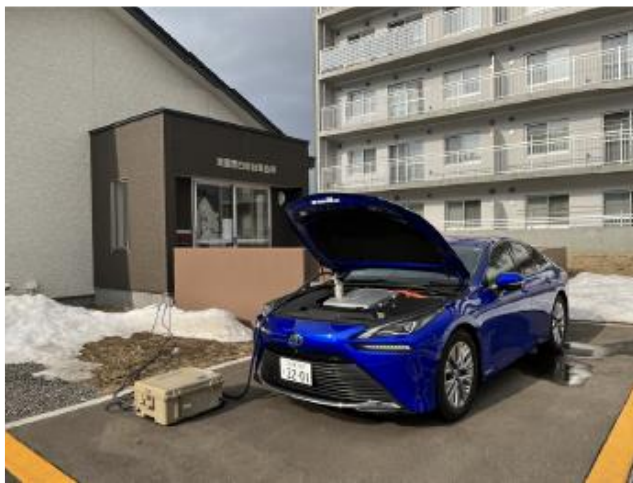
MIRAI⇒外部給電器（ニチコン(株)パワー・ムーバー®）で白鳥台集会所に給電開始
