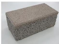
CO<sub>2</sub>硬化型セメントで製造した
