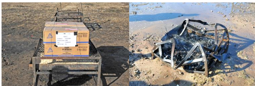
図 1 オランダの民生用花火で分類試験 (6 (c) 試験) が行われた。左は試験前の 4 つのパッケージ、右は試験後の試験台。テーブルは 4 mm の「L プロファイル」鋼で構成されている。火災が発生してから約 2.5 分後に、2 つの小さな火工効果が発生し、続いて大爆発が発生した。
